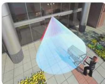
Tecnología de microondas e infrarrojos unida en un solo sensor, para una combinación de apertura de puertas puntual y seguridad para el peatón
